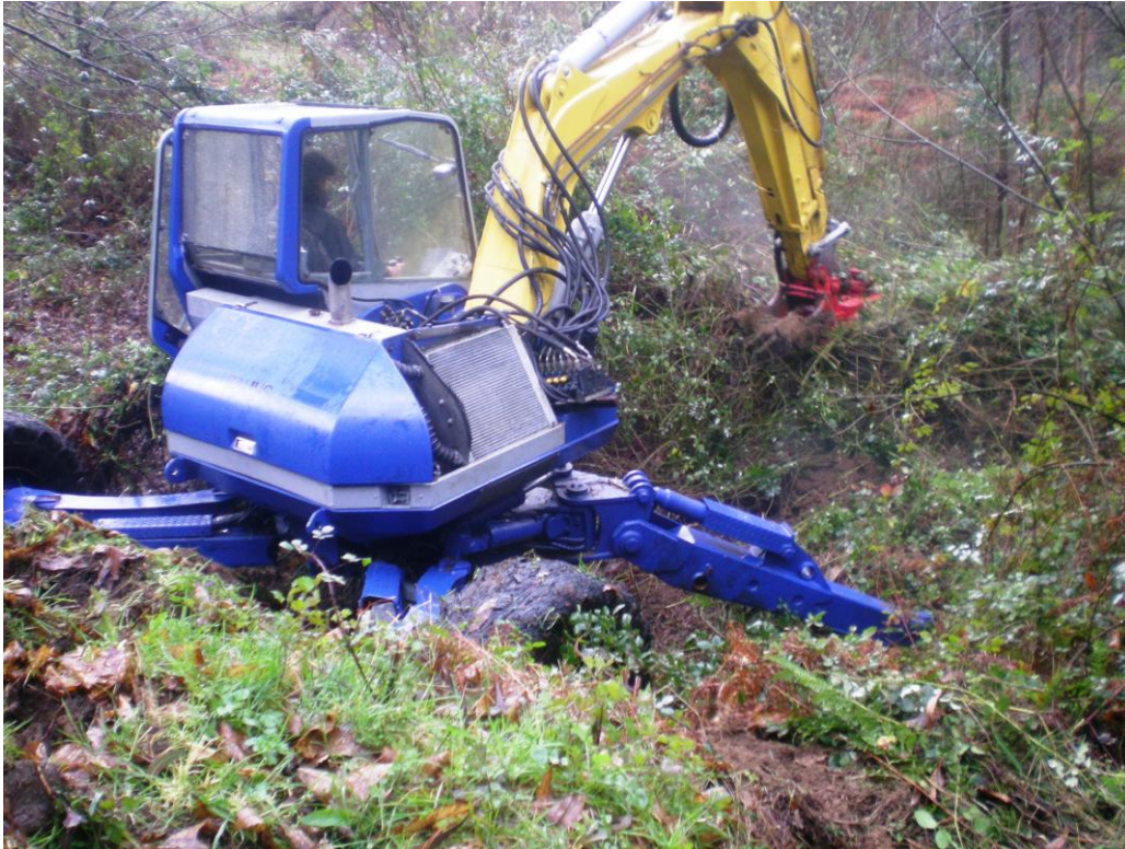
Desbroces con retroaraña en terrenos de pendiente (Valadouro 2011)
