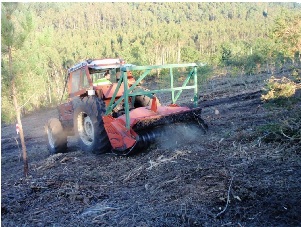
Trituración cepas y restos con rulo pesado, Santiago 2.010.
